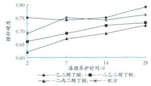
图 3 溶剂搭配后及单 溶剂对漆膜硬度的影响
